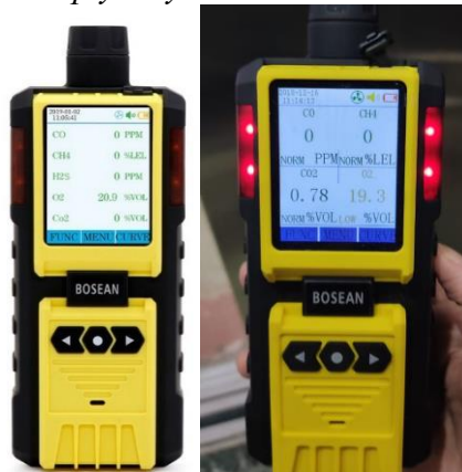
Obr. 2: Bosean K-600 multiplynový monitor vzduchu vrátane oxidu uhličitého
